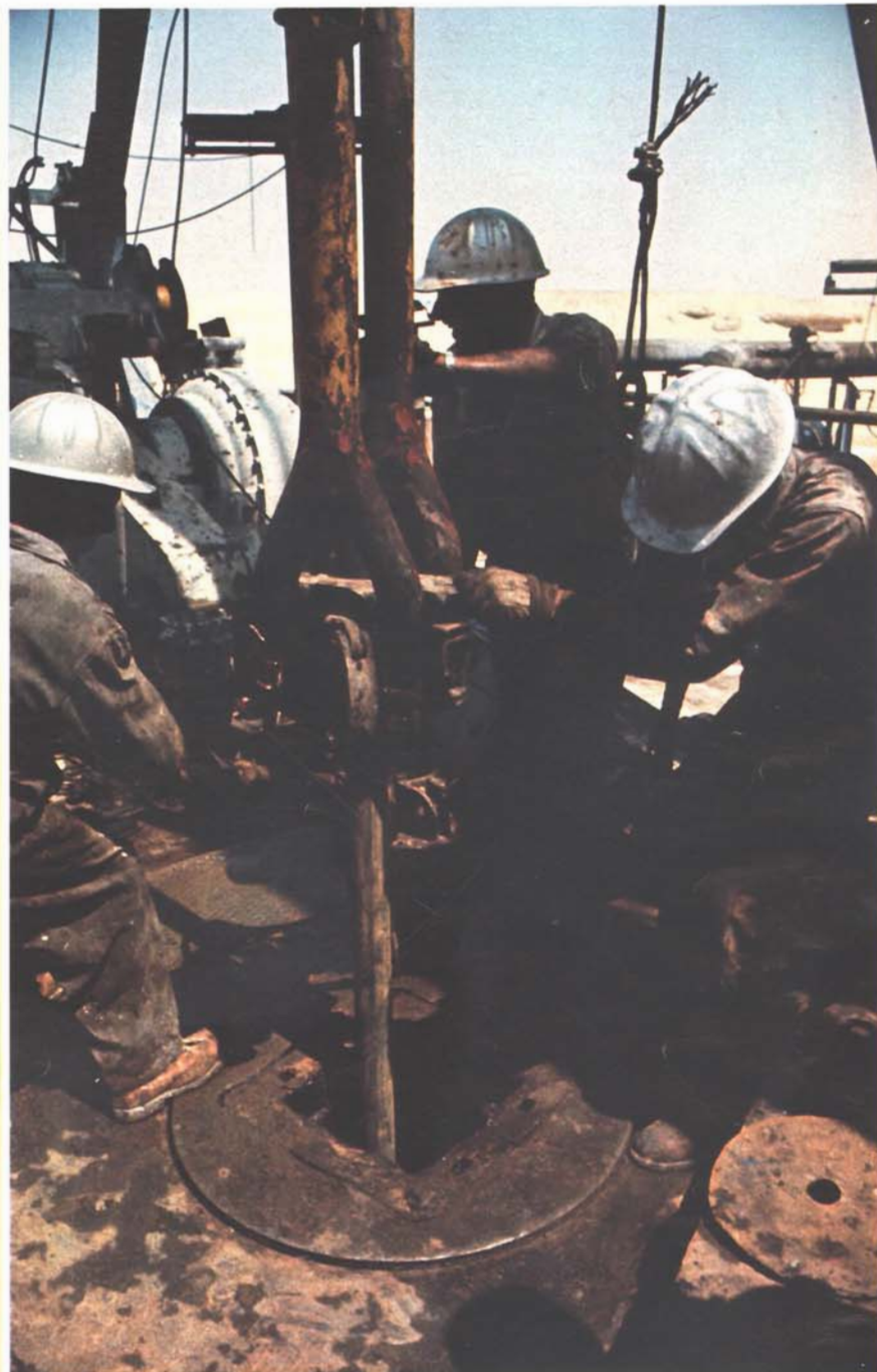
A sinistra: uno degli oleodotti che raccordano i vari pozzi di Zelten. Sopra: alcuni operai impegnati attorno a una trivella che scende nel sottosuolo fino a duemila metri di profondità. I pozzi di Zelten sono ora 160.
