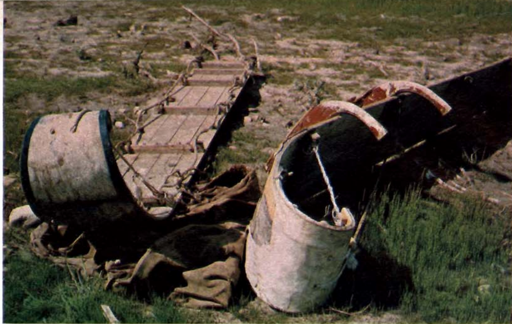
Due slitte degli indiani Atabaska, costruite con una solida intelaiatura di legno che è stata poi rivestita di pelle di caribù. Hanno una linea estremamente semplice e sono molto robuste: devono infatti servire al trasporto di grossi carichi per lunghi viaggi.
