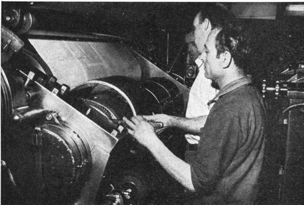
I cilindri di stampa, a seconda dell'importanza della rotativa, possono ricevere quattro od otto pagine semicilindriche di piombo. I rulli inchiostriatori sono di gomma. Sulle rotative dei quotidiani, i cilindri di stampa sono generalmente disposti a coppie: il primo cilindro imprime il *recto* della carta e il secondo il *verso*. Ogni macchina da stampa ha poi almeno una piegatrice la quale trasforma la striscia continua di carta in giornale finito: cioè innesta la carta, la taglia e la piega.
