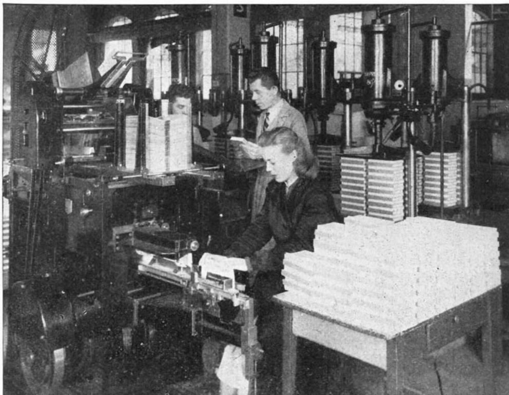
Una volta pronte le copertine, bisogna unirle saldamente alle pagine del libro cucito. A questa operazione provvede quest'altro reparto, con macchine veloci e precise.
